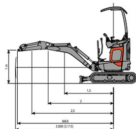
Hebekraft basierend auf ISO-Norm 10567 und überschreitet nicht mehr als 75% der Kipplast oder 87% der hydraulischen Hebe-Kapazität der Maschine.
